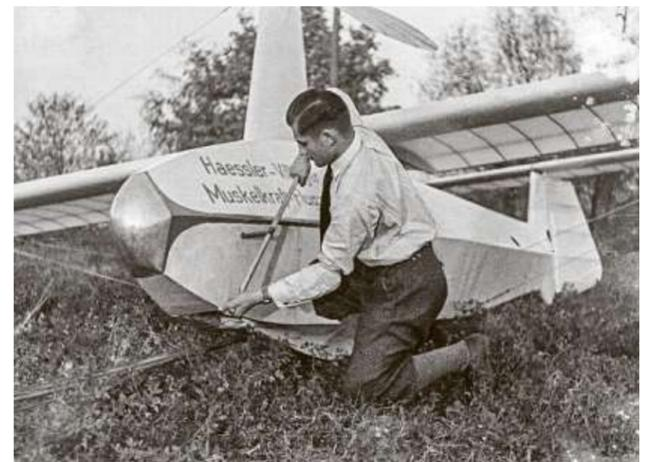
Helmut Haeßler beim Spannen der Gummibandwinde. Die Gummibänder beschleunigen das Flugzeug beim Start.
