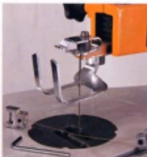
La lame de la Feider (lame à ergots) et celle de la Minilor peuvent être tournée de 90°, permettant de contourner la limitation du col-de-cygne. Mais sur la Feider le presser devient gênant.
