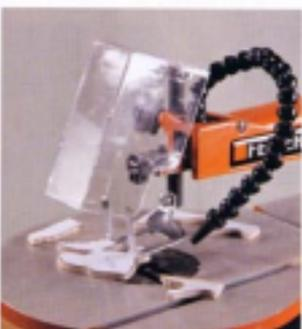
Le manie sécuritaire frappe aussi au-dessus. Delta et Feider protègent la lame avec un carter en plastique transparent solidifié du presseur. Encombrant, et plus gênant qu'utile.
