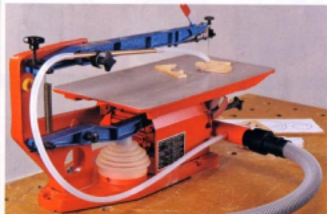
**Le branchement à un aspirateur** n'est pas indispensable, la quantité de sciure produite étant faible. Le soufflet de la Hegner peut être convertie en aspiration, raccordée à la sortie principale.
