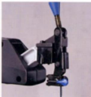
Delta et Dremel combinent le tendeur de lame et le levier de relâchement rapide en un seul dispositif. Si le relâchement rapide est utile, le gain apporté par la commande unique est peu flagrant.
