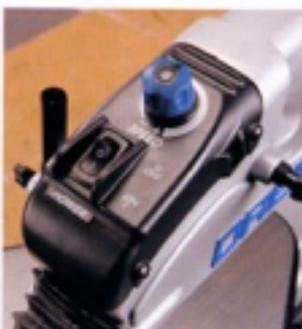
Sur une scie à chantourner, il est très courant de maintenir d'une main la pièce sur la table et de manipuler l'interrupteur de l'autre. D'où l'importance de commandes placées en évidence.
