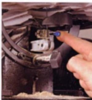
Plusieurs systèmes de maintien des lames coexistent : pincement par vis molette ou Allen, par levier, ou pinces à clié amovibles. Voir simple clips pour les lames à ergots (Feider).
