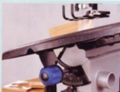
Pour incliner la table, il suffit en général d'agir sur une molette. Mais il faut d'abord desserrer un écrou sur la Minilor, et déposer le carter sur la Delta. La Dremel possède un index à bille.
