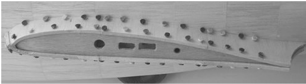
Coffrage en balsa tendre de 4 ou 5 mm
