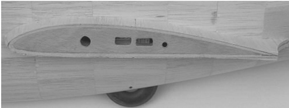
Coffrage en balsa tendre de 4 ou 5 mm
