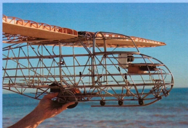
Trup modelu svařený stříbrem z nerezových trubiček
