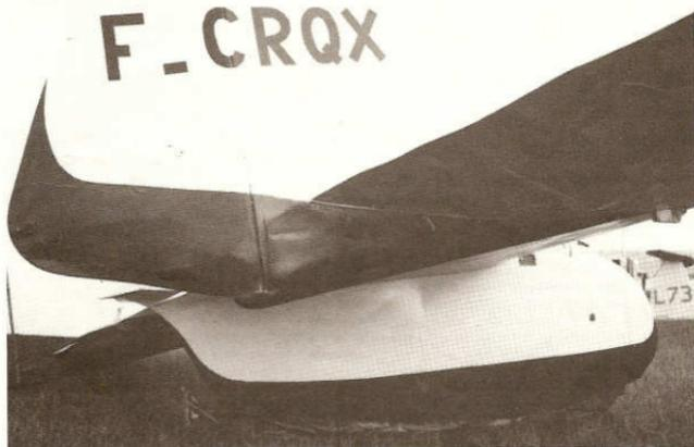
Vue de détail de l'AV 361 présentée en couleur page 39 - Remarquer le patin caréné, l'articulation des gouvernes de direction, le crochet Gc remorquage droit et le bord de fuite de la profondeur et des ailerons "tirés" par le revêtement - Outre la partie supérieure du fuselage modifiée par rapport à l'AV 36, les ailes sont prolongées de 13 cm au-delà de l'aleron.
