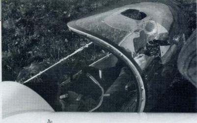
Notes le sens d'ouverture de la verrière, accompagnée par le tableau de bord, afin de faciliter l'installation du pilote.
