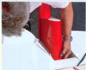
▲ Der Antrieb für das Trimmeruder im rechten Höhenruder ist recht traditionell
