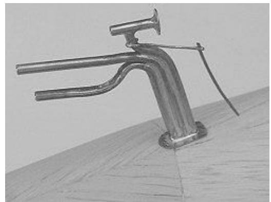
Tube Pitot en laiton de 2mm, soudé à l'étain
