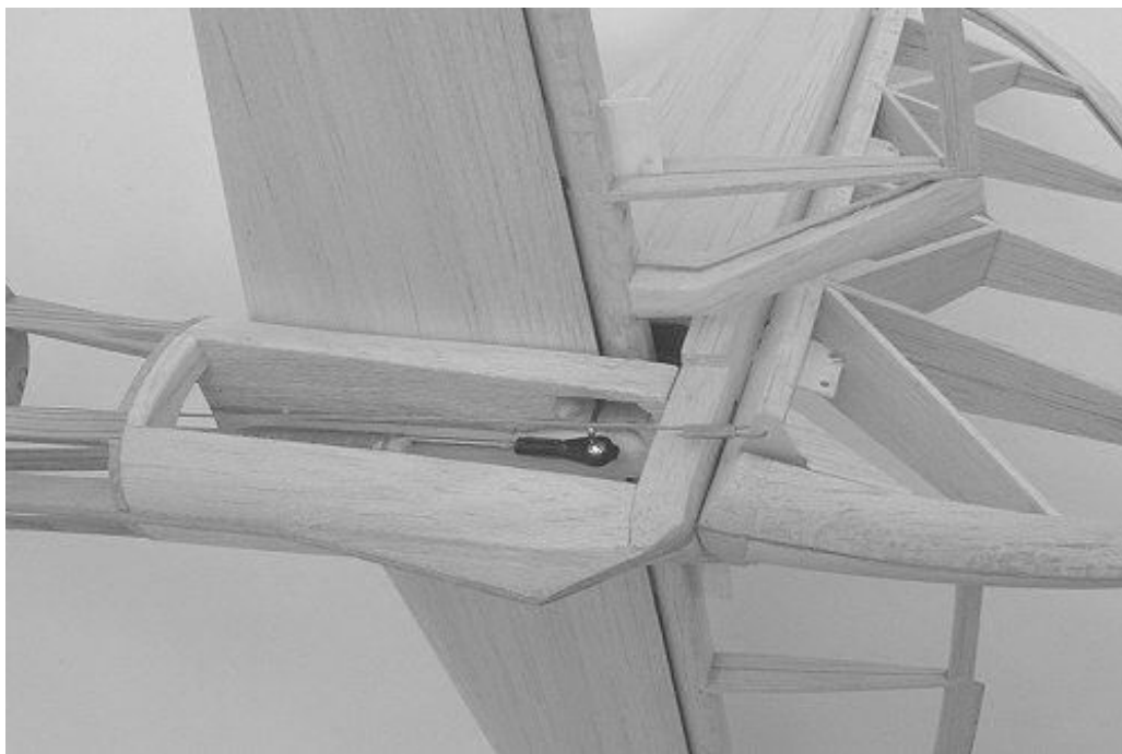
Commande du stab rigide par tourillon de hêtre de 6mm, prolongé par chape à rotule. La dérive est actionnée par câble aller-retour.
