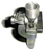
Usinage du passage de la chemise
