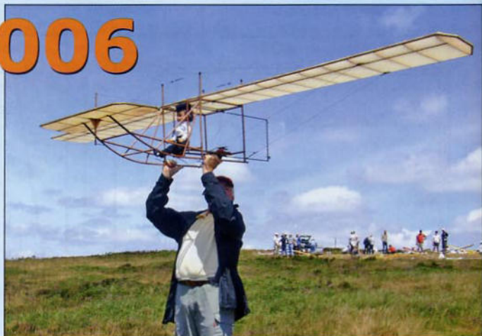
Model kluzáku z počátků letectví je opatřen „neviditelnou“ SOP z plexiskla
