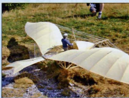
Model kluzáku z počátků letectví je opatřen „neviditelnou“ SOP z plexiskla
