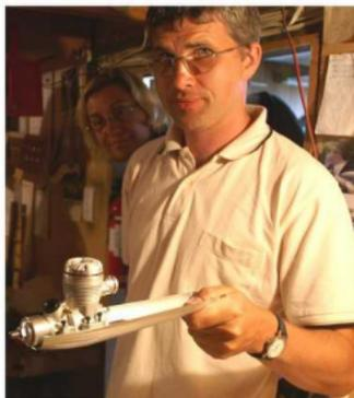
Un moteur de vitesse 5 fait à partir d'un Nelson 40 rechemisé. Il est présenté par Norbert Schmitz, de l'équipe de vitesse d'Allemagne et qui songe à s'installer en Nouvelle Zélande.
