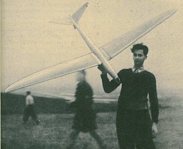
L'appareil d'Henri Varache, à l'empennage en V, est muni d'un pendule pour améliorer la stabilité longitudinale
