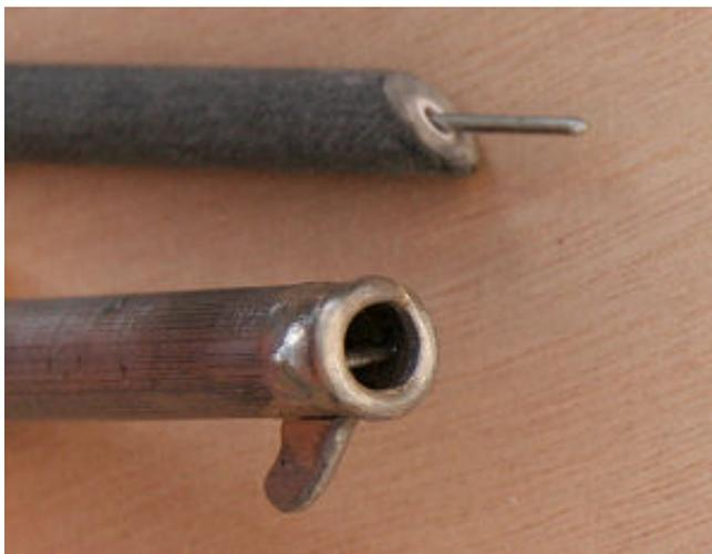
Le crochet de remorquage est classique, ce système se vend d'ailleurs en magasin de modélisme. Celui ci est récupéré dans le tube de jonction en acier des arceaux en fibre de verre de tente dôme, ces arceaux serviront ensuite de clés d'ailes... Ce tube s'enlève en le chauffant légèrement pour fondre la colle qui le tient à l'arceau.
