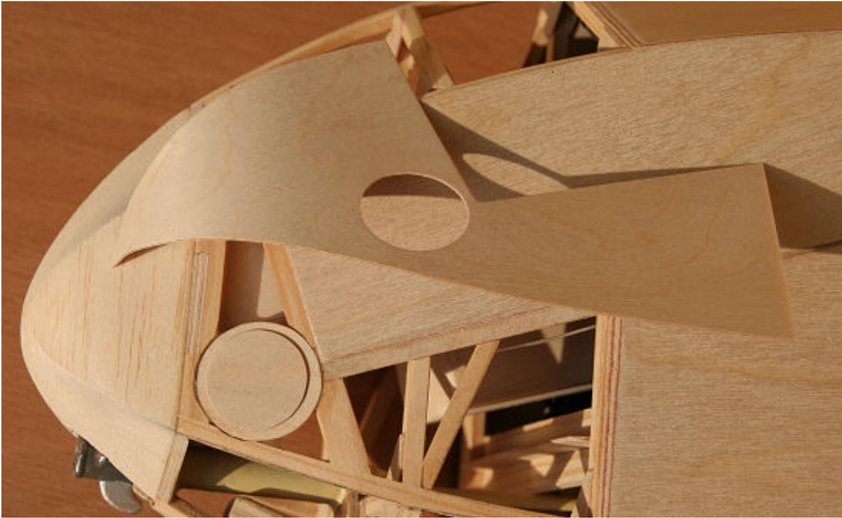
Coffrage du nez, c'est la dernière partie délicate à ajuster, les panneaux sont mouillés et mis en forme entre les doigts et séchés au petit fer, ils restent en forme et le collage se fait sans contrainte.
