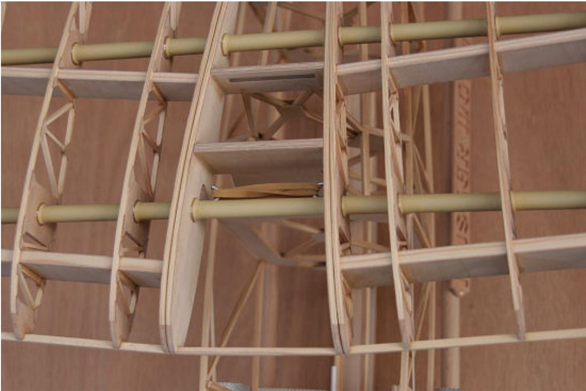
Les bords d'attaque sont en samba 5x4mm, plus facile à poncer qu'en pin. La jonction des ailes se fait par un élastique, c'est rapide à monter sur le terrain et ça reste souple en cas de choc. Les fourreaux en alu sont peints pour les camoufler le plus possible à travers l'entoilage.
