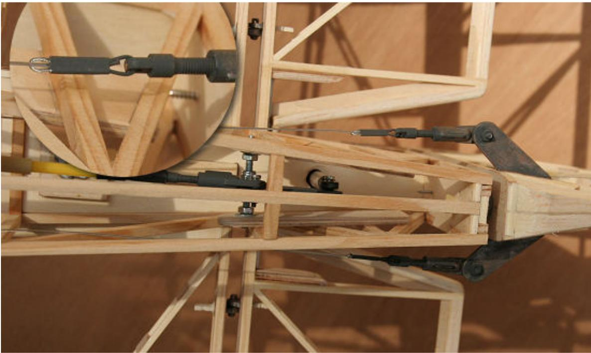
La commande de dérive est réalisée en aller/retour avec des câbles acier gainé plastique. Les extrémités des câbles passent 2 fois dans les tubes de sertissage pour éviter tout glissement. Ils sont repris par un palier en époxy monté sur roulement à billes. La commande de profondeur est reliée par une gaine Sullivan.
