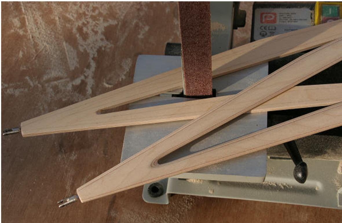
Le ponçage est dégrossi à la ponceuse à bande verticale, ça se fait à l'oeil en se guidant sur la régularité des plis du CTP, on peut également dégrossir avec une râpe à bois.
