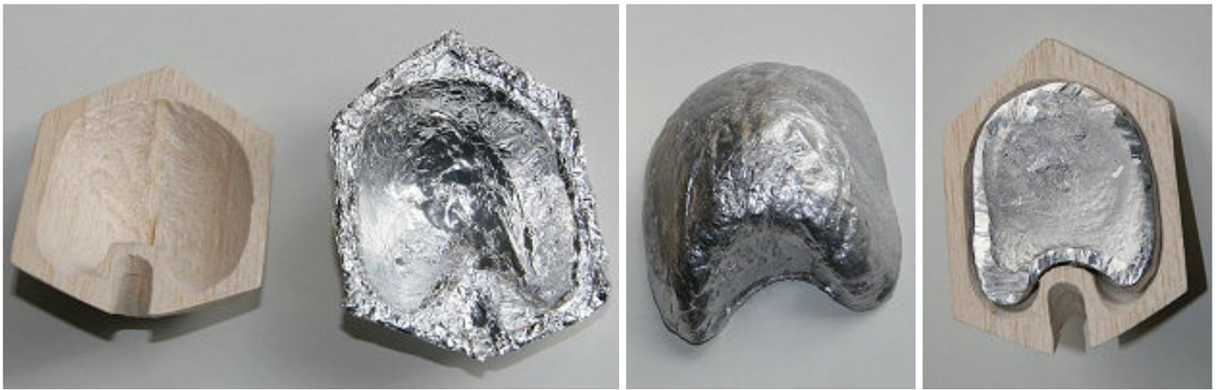
Le nez en balsa est évidé, quelques couches de papier aluminium sont appliquées dans le nez pour faire un moule, les bords sont relevés et roulés pour raidir le moule. Le plomb est coulé dans ce moule, ce qui donne une masse de 440g. Le planeur est centré un peu avant avec ce plomb, ce qui devrait compenser le poids que fera l'entoilage de l'empennage et le vernis sur l'arrière. Le plomb est collé avec le nez à l'Araldite lente.
