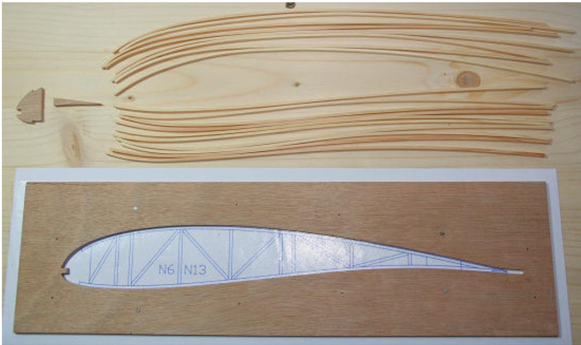
Le moule est positionné et pointé sur le tracé en intercalant une feuille plastifiée. Les baguettes de pourtour sont pré-cintrées en les mouillant et les séchant au petit fer à entoilier, c'est une opération que l'on peut éviter, mais je trouve que cela facilite l'ajustage et évite des contraintes aux collages surtout au niveau du bec de bord d'attaque.
