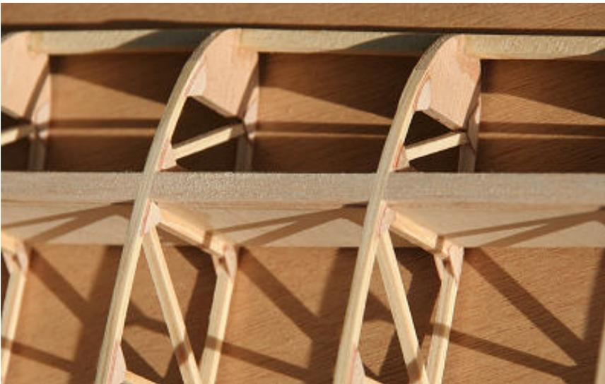
Un garnissage en balsa est collé entre les nervures sur le longeron poutre afin d'assurer le collage des coffrages en ctp de 0.6mm.
