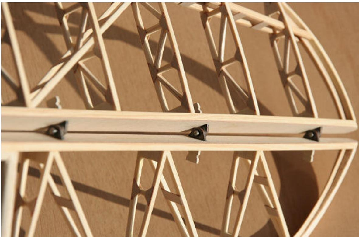
Même travail sur la partie fixe de stab, les nervures sont collées en vérifiant bien l'alignement avec l'équerre, les 2 nervures opposées sont collées en premier, et ensuite les intermédiaires, ce qui permet de vérifier l'alignement avec une baguette de bord d'attaque. Les bord d'attaques en samba 5x4 sont collés puis les longerons en pin 4x2mm.
