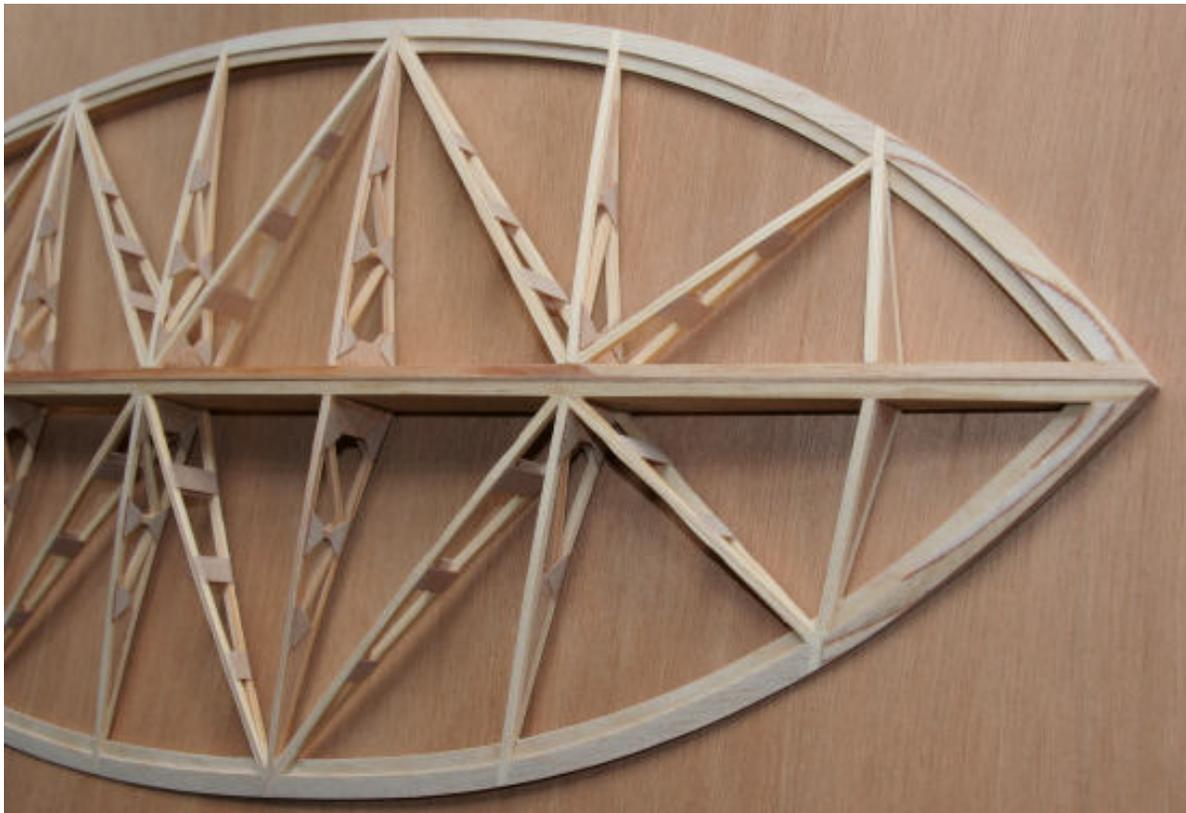
Les nervures en biais sont en baguettes de pin 3x2mm ajustées et collées, des écarteurs en CTP de 0.4mm maintiennent la forme entre ces baguettes d'extrados et d'intrados. Il aura fallut **53m** de baguettes
