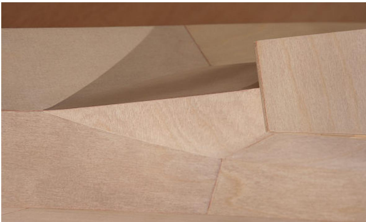
Le coffrage de la pointe arrière de la cabane est assez délicat, les 2 panneaux sont cintrés sur plusieurs plans et la jonction doit se faire avec une belle arrête vive.
