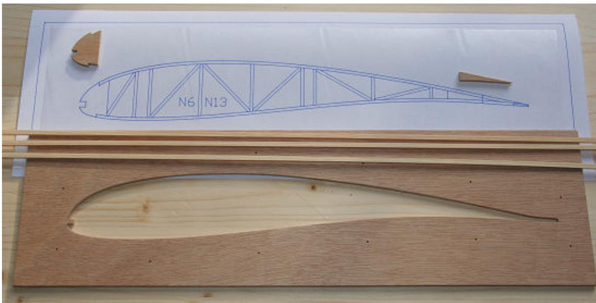
Découpe de la forme de nervure de la partie droite de l'aile dans du CTP de 3mm, il y a 28 nervures à construire dans ce moule. La structure est en baguettes de pin 3x2mm, sauf les montants verticaux entourant les longerons qui sont en pin de 3x3mm.
