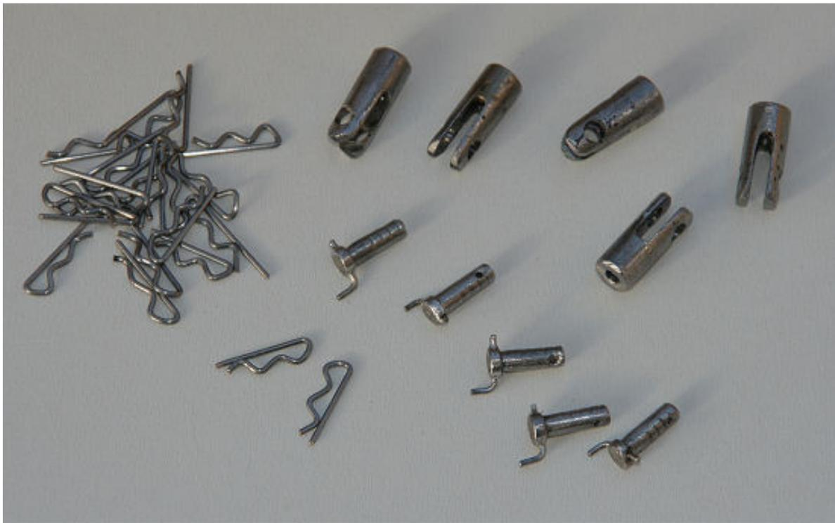
L'attache de hauban côté fuselage en dural de 2mm
