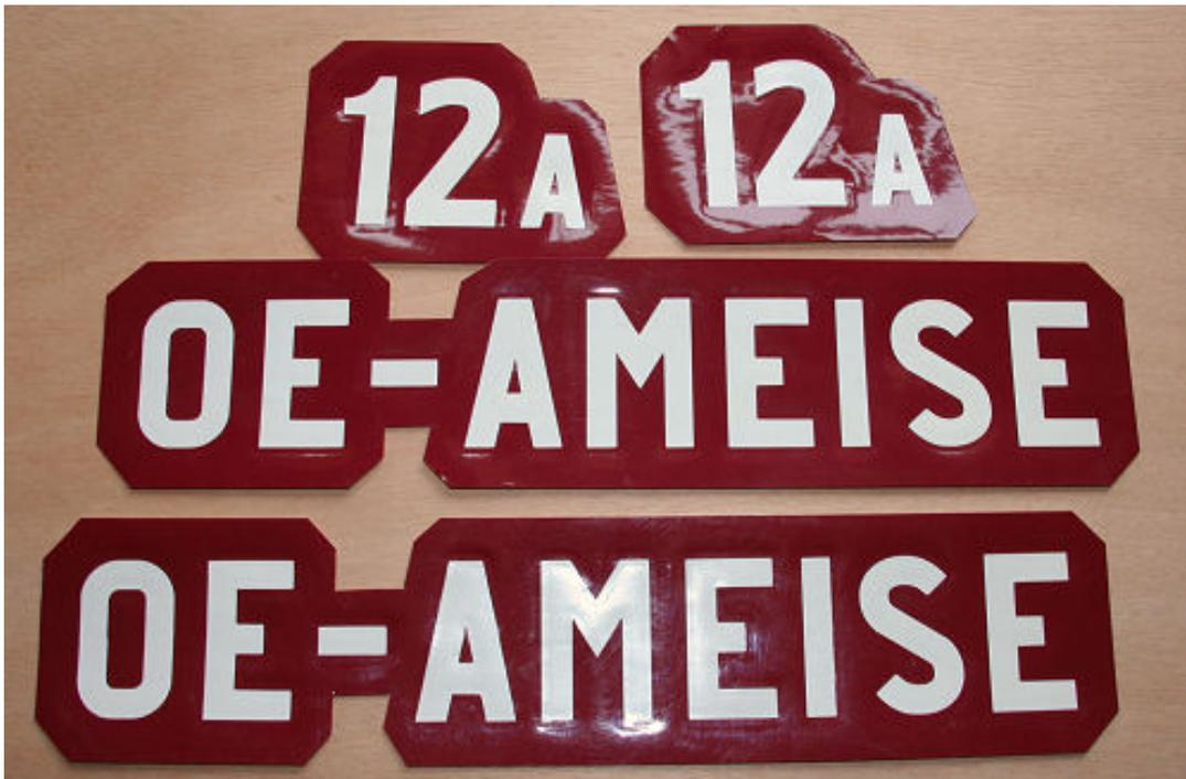
Découpe des pochoirs en vinyl à la CNC. Du scotch large est posé sur le vinyl afin de positionner l'ensemble sur le fuselage. La peinture est faite à la Humbrol gris foncé mat, le vinyl est aussitôt enlevé avant que la peinture soit sèche
