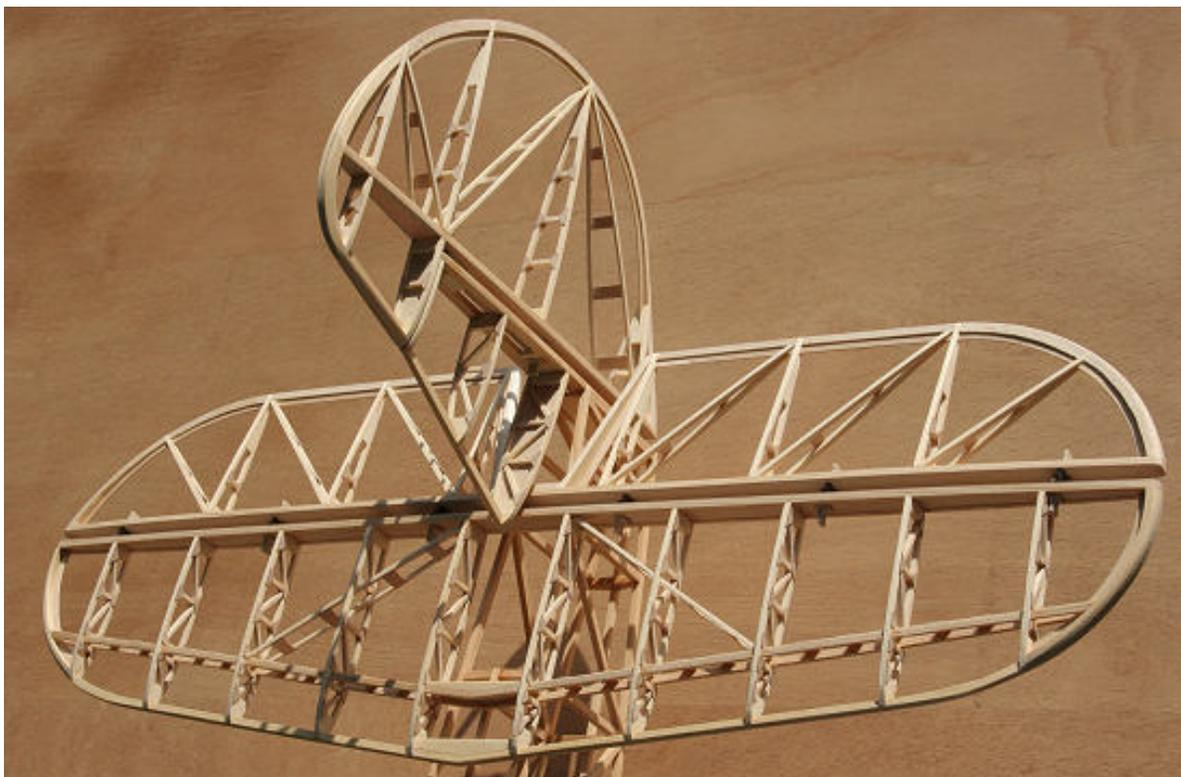
L'aile du MG12 est composée de 23 nervures dont 13 à corde constante + celle d'emplanture fuselage, les autres s'élargissent au milieu de l'aileron et diminuent ensuite au saumon. Cette fois-ci les nervures vont être construites en structure, cela fait longtemps que j'en avais envie mais je n'avais jamais osé, ni prit le temps de le faire.
