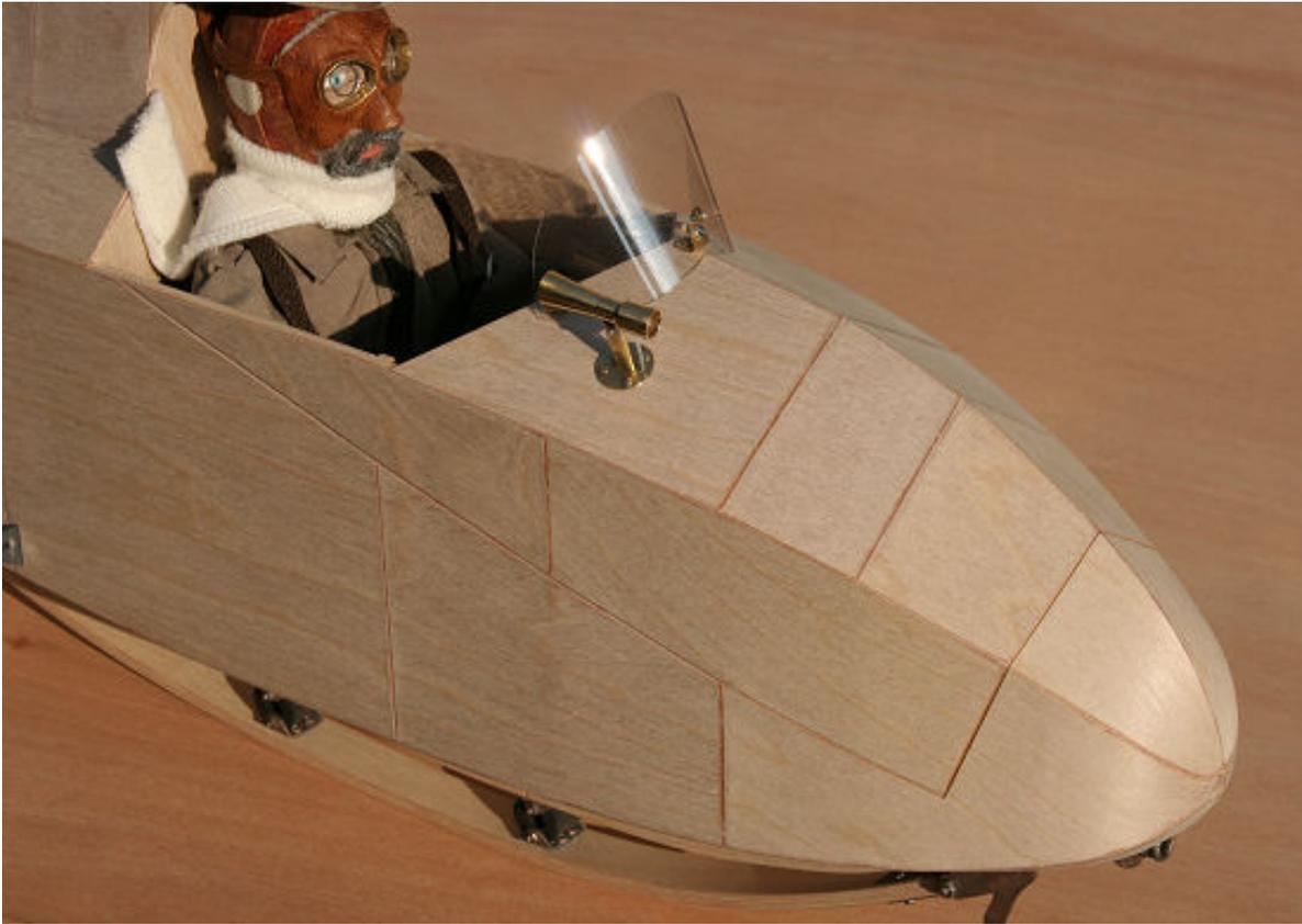
Le fuselage est terminé, la partie supérieure qui s'ouvre sur le grandeur est simulée par un espace de 0.5mm entre les panneaux, ce faux joint sera réhaussé avec une teinte foncée ou de la peinture. Je n'ai pas de regret de l'avoir fait fixe, étant donné qu'il n'aurait pas été possible de dissimuler le récepteur, l'accus et tous les fils, cette option est néanmoins envisageable sur une construction plus grande.
