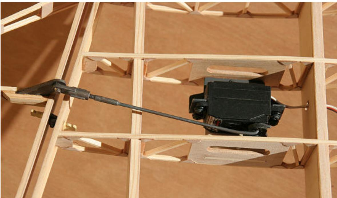
Les servos d'ailerons sont fixés sur des platines en dural de 1mm qui sont vissées sur un plancher en CTP
