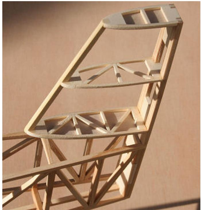
Les nervures de la partie fixe de dérive sont en structure de pin 3x2mm et CTP peuplier 3mm, une pesée juste par curiosité: 2.1g pour ces 3 nervures, je ne pensais pas que ça puisse être aussi léger.
