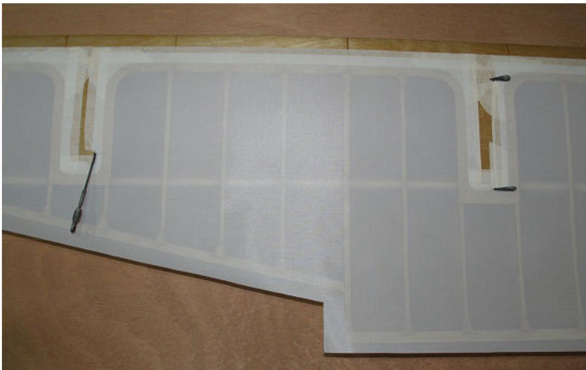
Pointage au fer sur le pourtour et collage en insistant jusqu'à avoir une couleur uniforme et sans bulle d'air, s'aider d'un sopalin pour appuyer le tissu chaud sur le bois vernis pour éliminer les bulles d'air.
