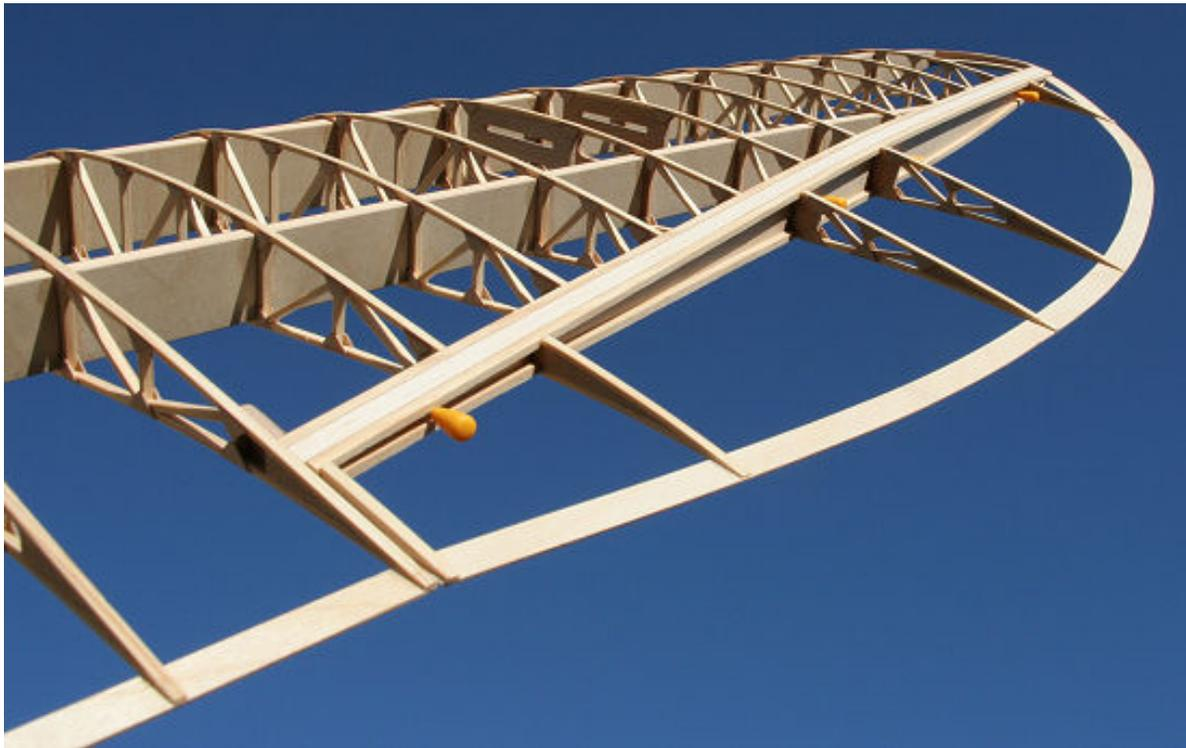
Les nervures d'ailerons sont construites en structure de pin 3x2mm comme celles des ailes. Le bord de fuite est découpé dans du ctp de 1mm, les nervures NA1 et NA8 sont collées sur le longeron d'aileron et avec le bord de fuite. La nervure NA5 centrale est collée en vérifiant bien sa position avec un gabarit d'intrados, les nervures intermédiaires sont ensuite collées en contrôlant le bon alignement du bord de fuite.
