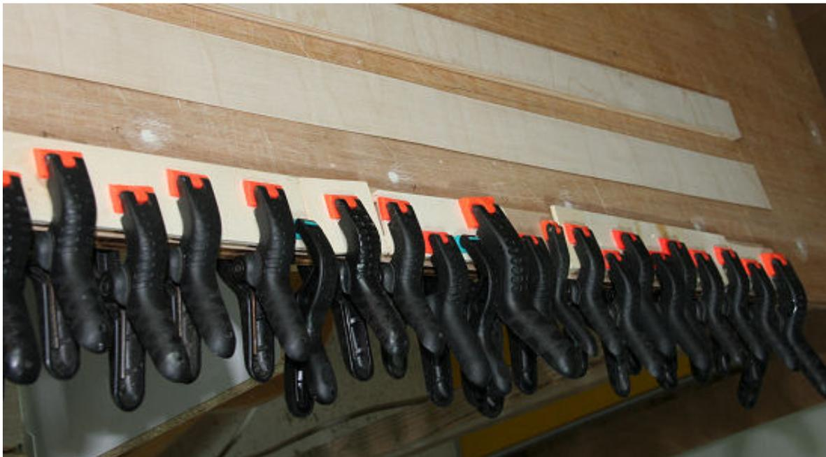
Le treillis est collé sur une bande de CTP 0.8mm fibres verticales d'environ 5mm plus large. Après séchage le CTP est recoupé au cutter en se guidant sur le pin, puis la 2eme face en CTP est collée.
