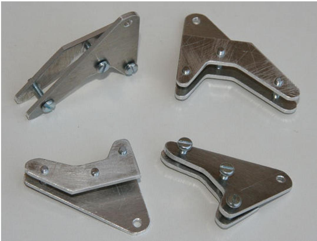
Les contres plaques d'attaches sont taraudées à 3mm afin de se passer d'écrous.
