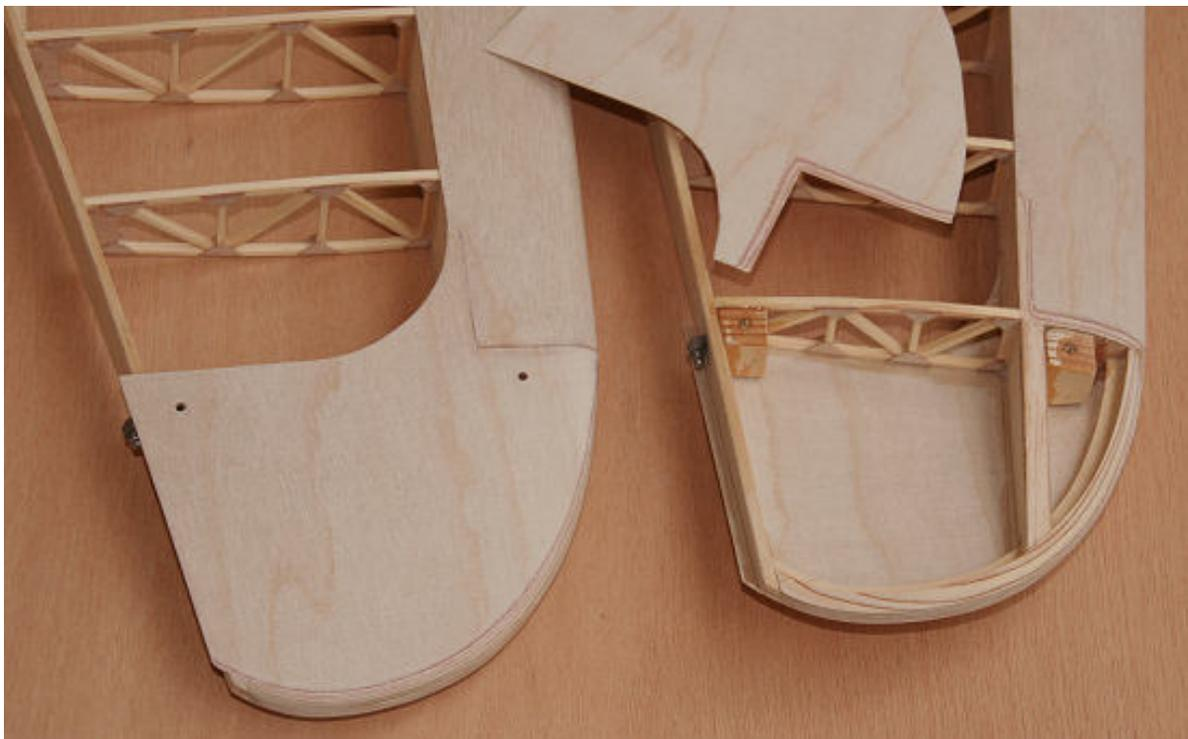
Il est indispensable de mettre des balancelles assez hautes et rapidement démontables, pour protéger les ailerons, car ce sont eux qui touchent le sol à l'arrêt. Des blocs de pin et tubes laiton sont collés à l'époxy sur la dernière nervure, cela permet de maintenir solidement les balancelles en CAP de 1.5mm. Le CTP de 0.6mm déborde de 3mm pour minimiser la fente des ailerons.
