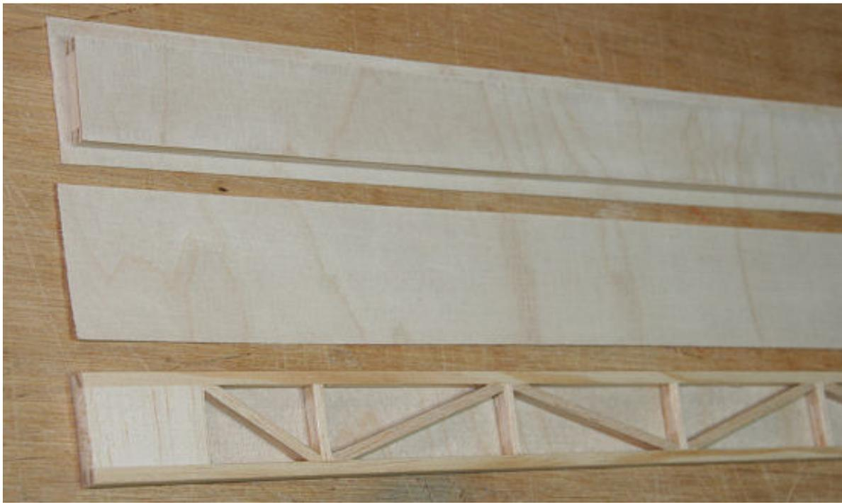
Les longerons de la partie arrière des ailes sont construits sur le même principe, mais avec des sections de pin plus faible 5x3mm et coffrage CTP de 0.6mm
