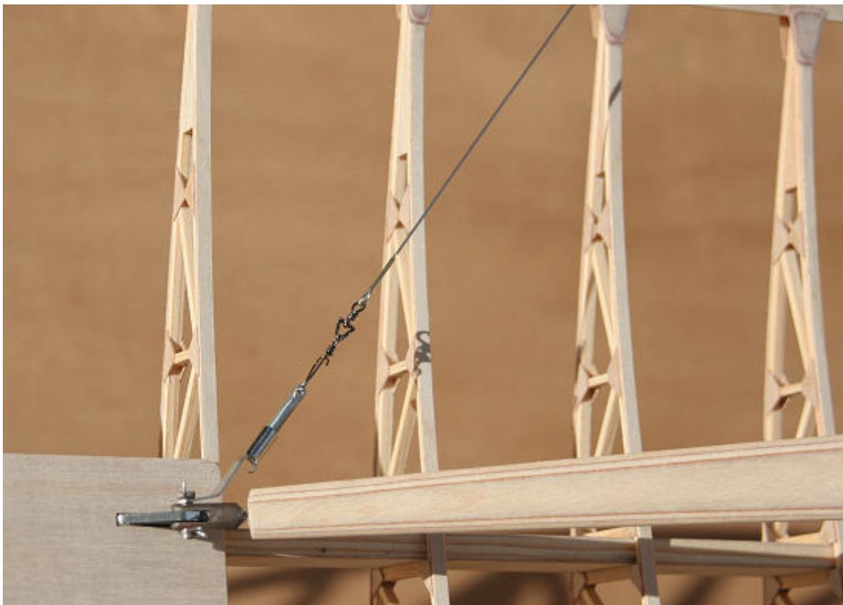
Les câbles de triangulation sont fixés par les goupilles des haubans et sur la vis du stab, un émerillon de pêche permet la tension avec la vis, une fois monté, sans vriller le câble
