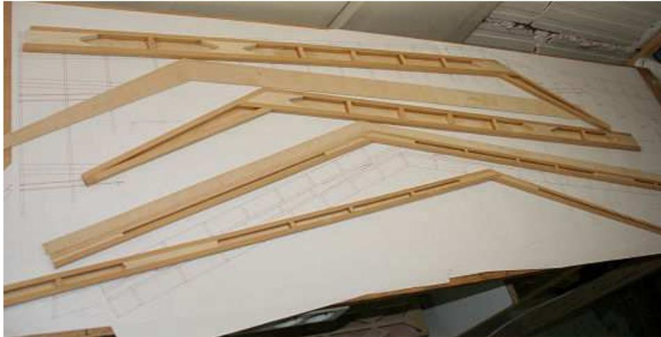
Les baguettes en red cedar sont coupées à la scie circulaire de table dans un clin de bardage. Pour le longeron principal avant, ce sont des 8x8mm et celui arrière, baguettes de 6x6mm. Les baguettes sont collées à la vinylique sur une face du CTP, une par une, afin de bien les aligner à la règle. Une fois sec et surfacé, l'autre face du CTP est collé pour refermer la poutre.
