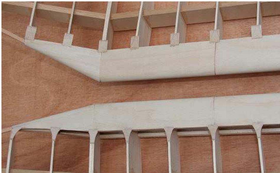
Les goussets sont mis en forme après collage, découpe à la mini lame circulaire et finition au tambour ponceur.
