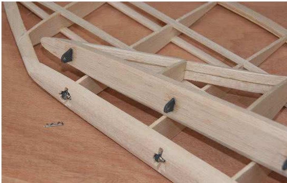
Les charnières sont en époxy cuivré double face, les axes sont tirés dans des clous de 2.7mm de diamètre et soudés à l'étain, une goupille Beta verrouille le volet de dérive, l'ensemble est peint en gris mat et sera vieilli par la suite.
