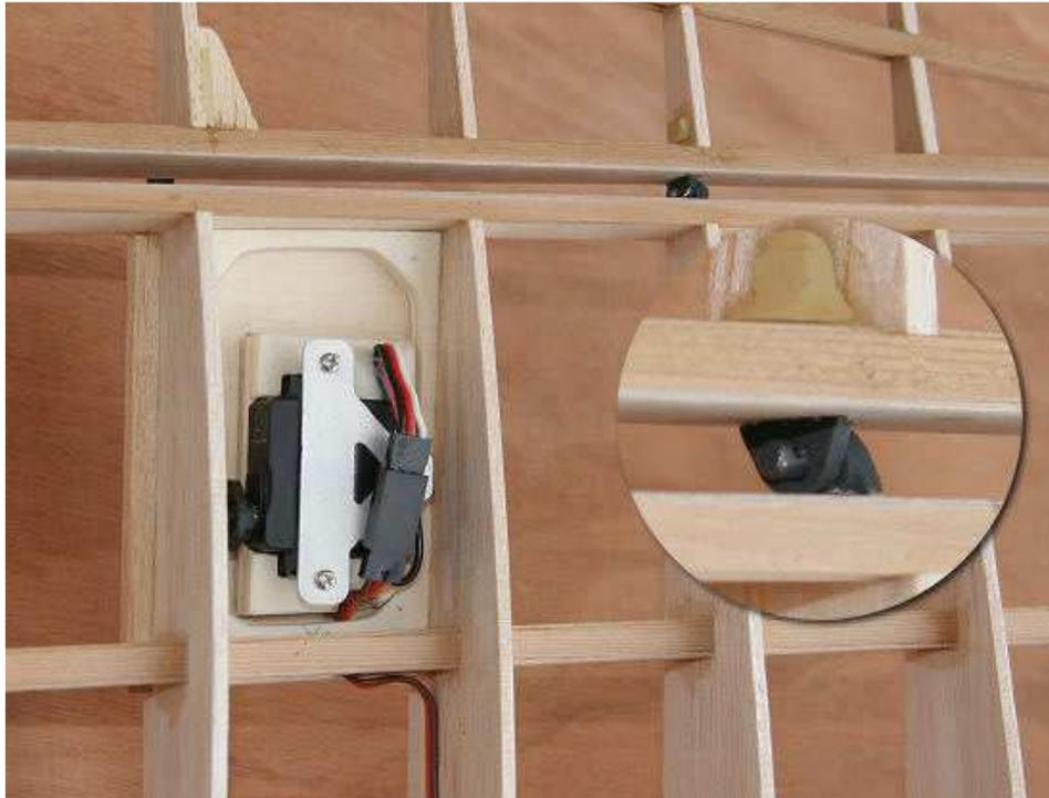
Les charnières côté aileron, sont pointées à la cyano, seulement les 2 aux extrémités, puis pointage des 2 autres, côté aile. Les charnières intermédiaires sont ensuite collées. Il ne doit y avoir aucun point dur, l'aileron doit tomber de son propre poids. Puis congé d'époxy sur les bouts des charnières.
