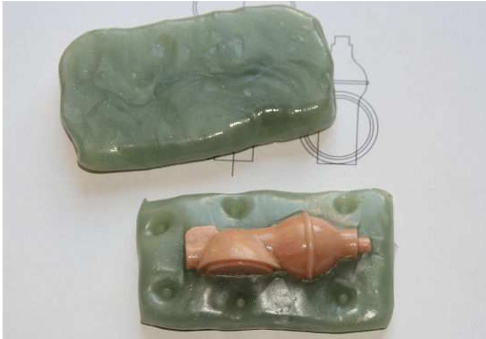
La Super Sculpey durcit en la cuisant au four, mais reste trop fragile pour être utilisé sur le planeur. J'en ai tiré un moule avec de la pâte Oyumaru. C'est une pâte qui se ramollit dans l'eau bouillante, et qui est réutilisable à l'infini, bien pratique pour mouler rapidement des petits objets. Une fois ramollie, la pâte s'utilise pendant environ 1mn, le durcissement se fait en 1/2h, on peut ensuite mouler la partie du dessus.
