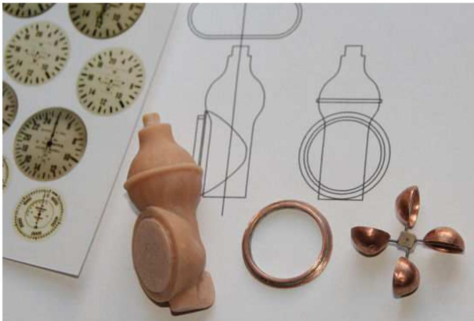
Les godets en cuivre sont embossés avec un poinçon fait dans une tige de fer de 8mm arrondi au bout, la finition est faite en martellant doucement sur le poinçon. Ces ailettes sont soudées sur des CAP de 0.8mm et sur la partie centrale en laiton 4x4mm. Le tour du cadran est fait avec une rondelle de cuivre sur laquelle est soudé un anneau tiré d'un tube de plomberie 22/24. Le cadran est une impression sur papier photo brillant en utilisant comme modèle celui du réel.
