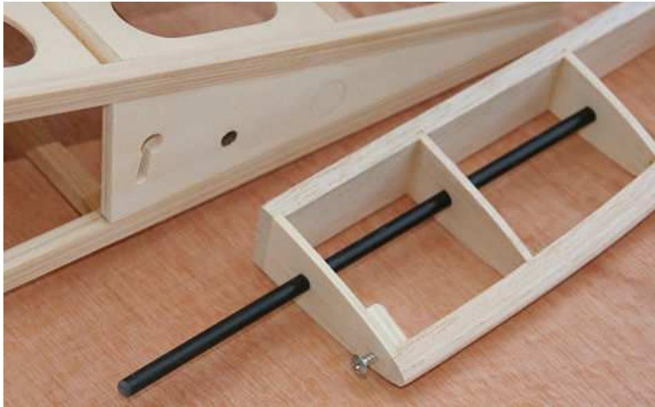
La fixation des parties fixes sur le fuselage, se fait de la même façon que la dérive, on enfle la clé dans le fourreau et on pivote le stab vers le bas.
