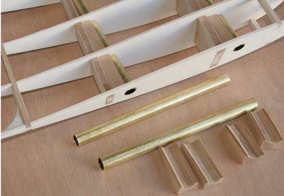
Des blocs en red cedar solidarisent les fourreaux de clés d'aile sur les longerons
