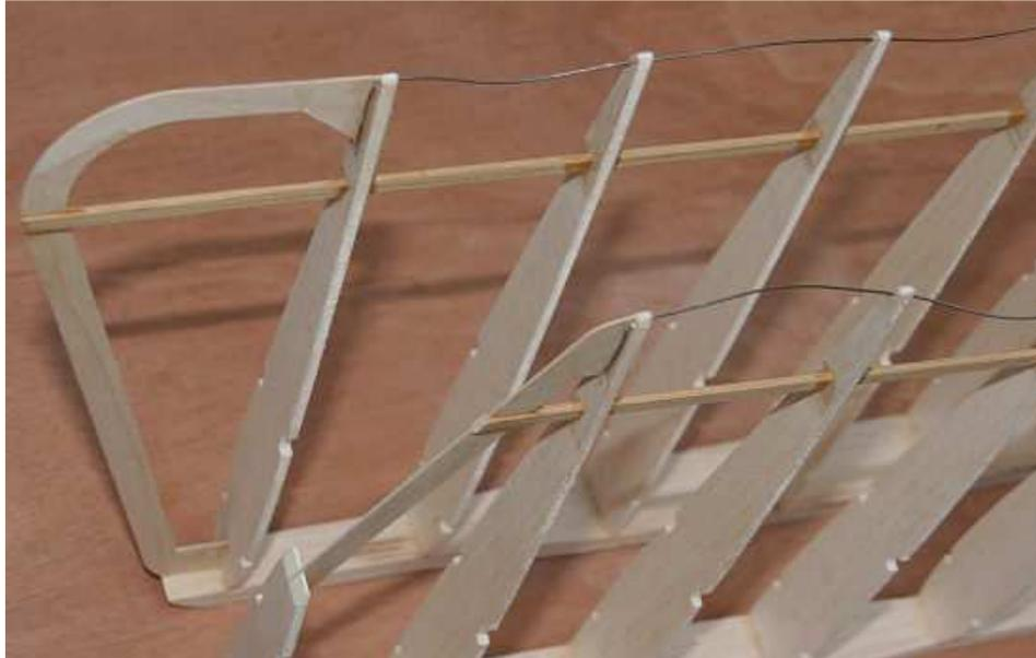
Les bords de fuite sont en câble de 0.8mm replié et collé en bout, il y a 1mm de mou entre chaque nervure, afin d'avoir un cintrage bien visible lors de la tension de l'entoilage.
