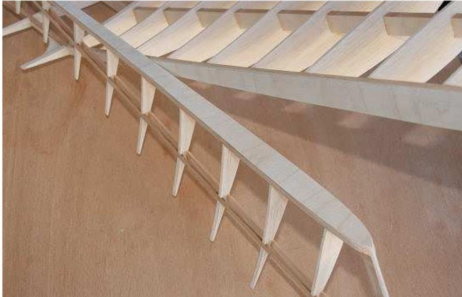
Les ailerons sont détachés, collage d'un ctp de 0.6mm fibres verticales pour limiter la torsion.
