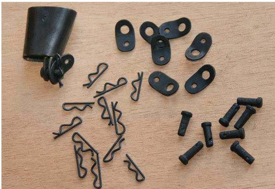
Les ferrures pour attacher les câbles en diagonale, les goupilles d'axes et les goupilles beta en CAP de 0.8mm.
