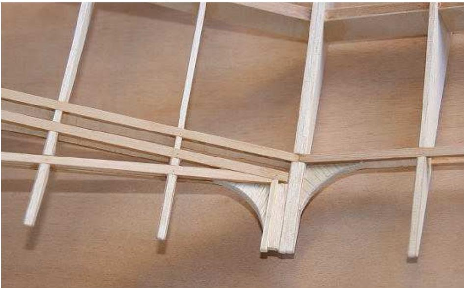
Des renforts sont collés sur les queues de nervures aux extrémités, afin d'éviter la déformation due à la tension de l'entoilage sur les câbles de bord de fuite.
