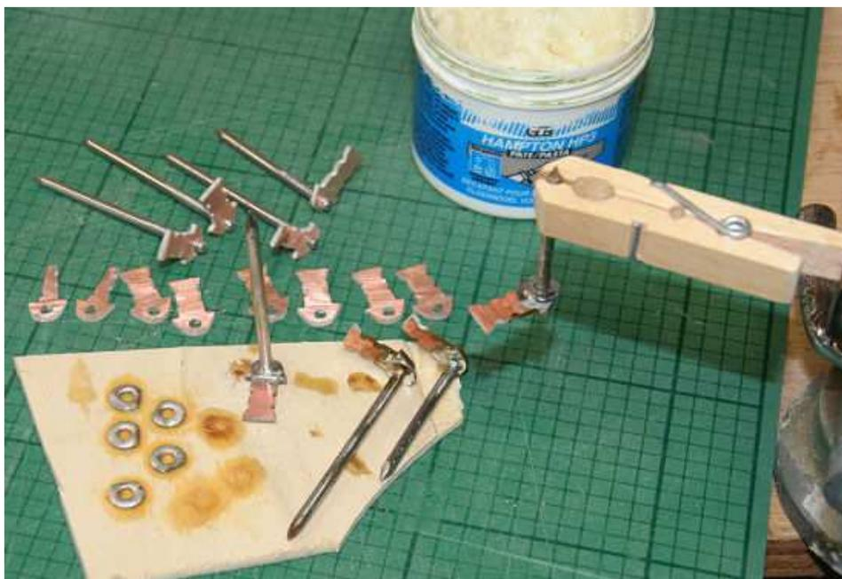
Les charnières sont découpées dans de l'époxy cuivré double face. Côté aile le perçage est fait à 2.8mm pour rentrer en force les axes tirés dans des clous de 3mm. Côté aileron, perçage à 3.2mm pour s'articuler librement. Les clous sont brasés à l'étain, en ajoutant une rondelle servant de palier.
