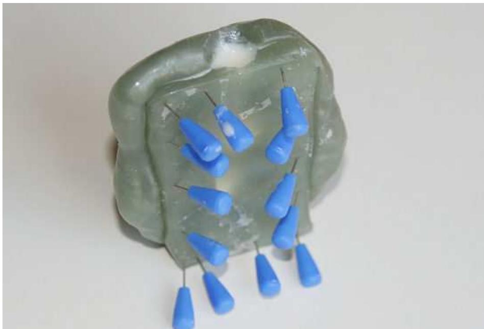
Le moulage est fait en résine polyuréthane 2 composants, 30mn après le coulage on peut démouler. Il ne reste plus qu'à ébavurer le plan de joint.
