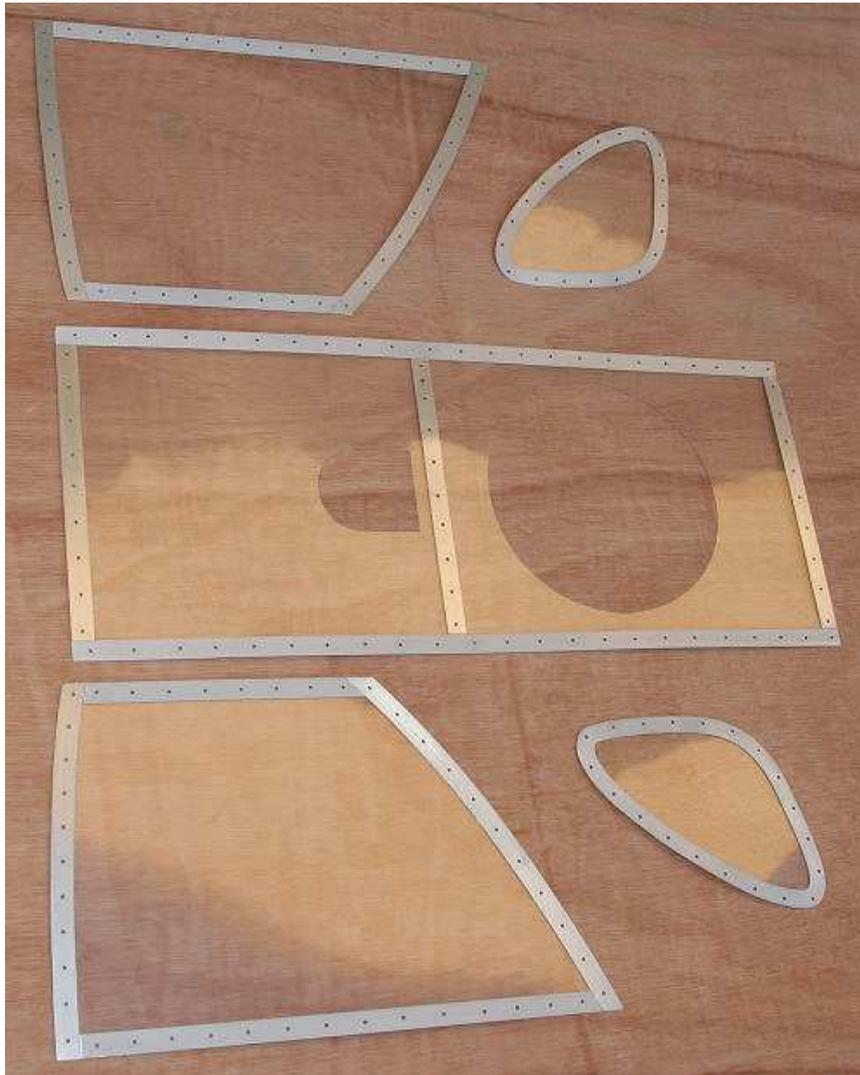
Les vitrages sont découpés, les entourages sont en tôle d'aluminium de 0.2mm collés à la néoprène. Ils sont tenus par 200 petites vis, donc démontables pour accéder éventuellement à l'aménagement intérieur.
