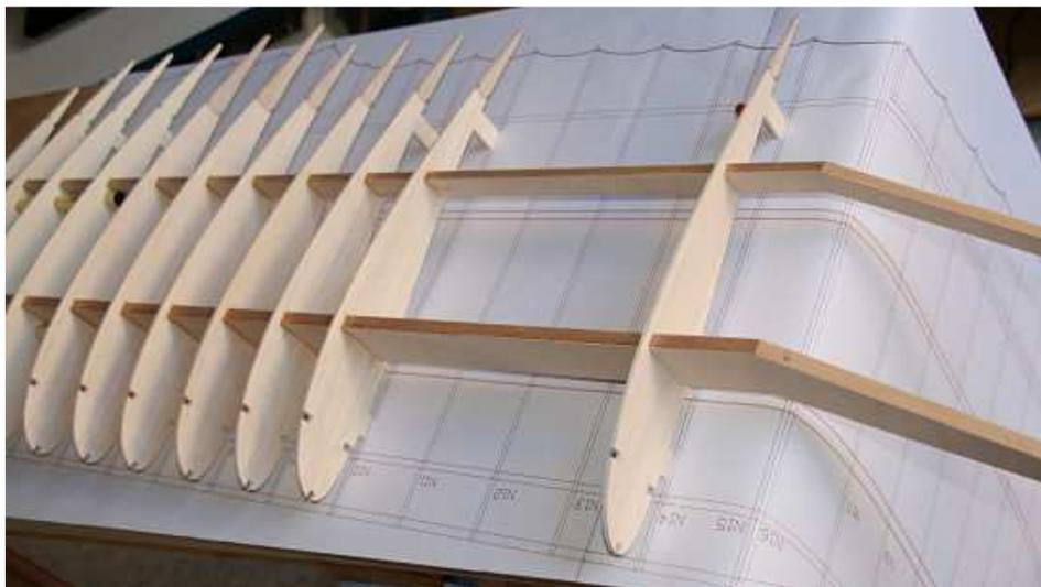
A ce stade de collage, N14 n'est bien sûr pas collée, afin d'enfiler les autres nervures, N14 sert juste à caler correctement l'aile sur plan
