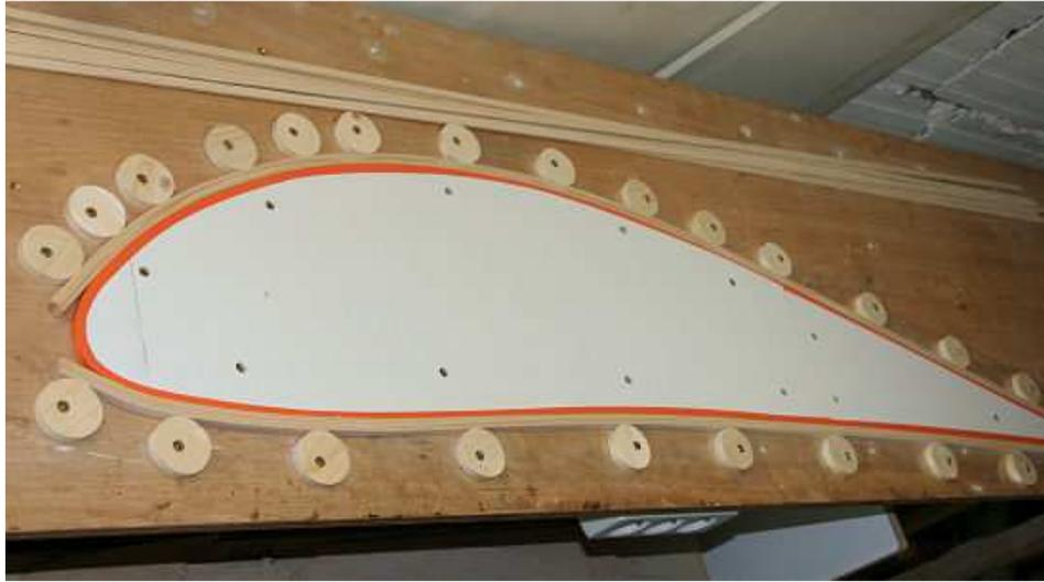
Les lisses hautes et basses sont tirées à la scie circulaire de table dans des tasseaux de pin de 9mm d'épaisseur. Il y a 3 épaisseurs de 3mm contre-collées. Le pressage contre le gabarit se fait avec des excentriques (rond de bois avec perçage décentré)
