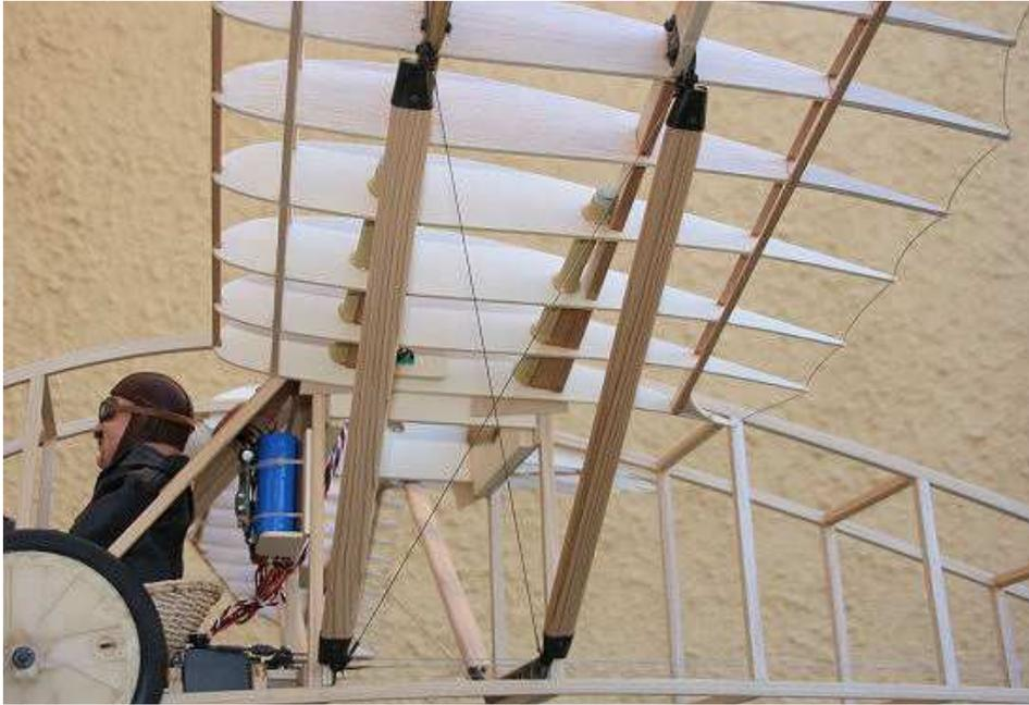
Les haubans sont profilés dans du red cedar, les embouts métalliques sont maintenus par une vis de 2mm.
