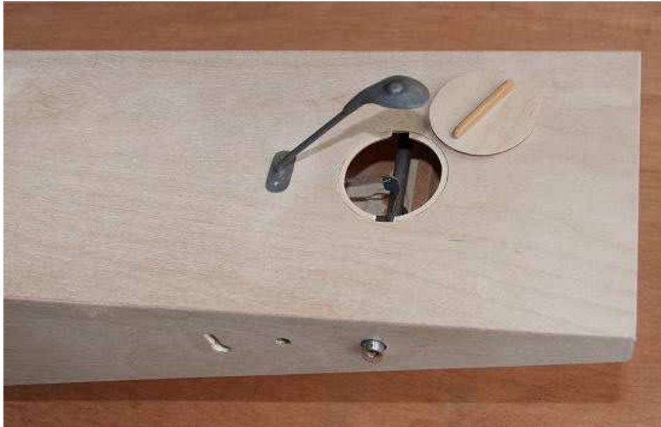
Le fuselage est coffré en CTP de 0.4mm jusqu'aux clés d'ailes, l'avant est coffré en 0.6mm. A l'arrière, trappe de visite 1/4 de tour au cas où...
