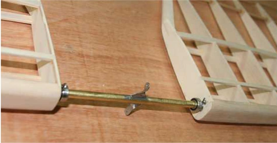
A chaque extrémité du tube laiton, sont soudées des bagues acier (faites à partir d'écrous de 8mm) ces bagues servent de butée aux roulements et aussi à épaissir le perçage recevant la goupille de verrouillage des volets. Quand les volets sont verrouillés au tube, tout doit être bien bloqué sans jeu.
