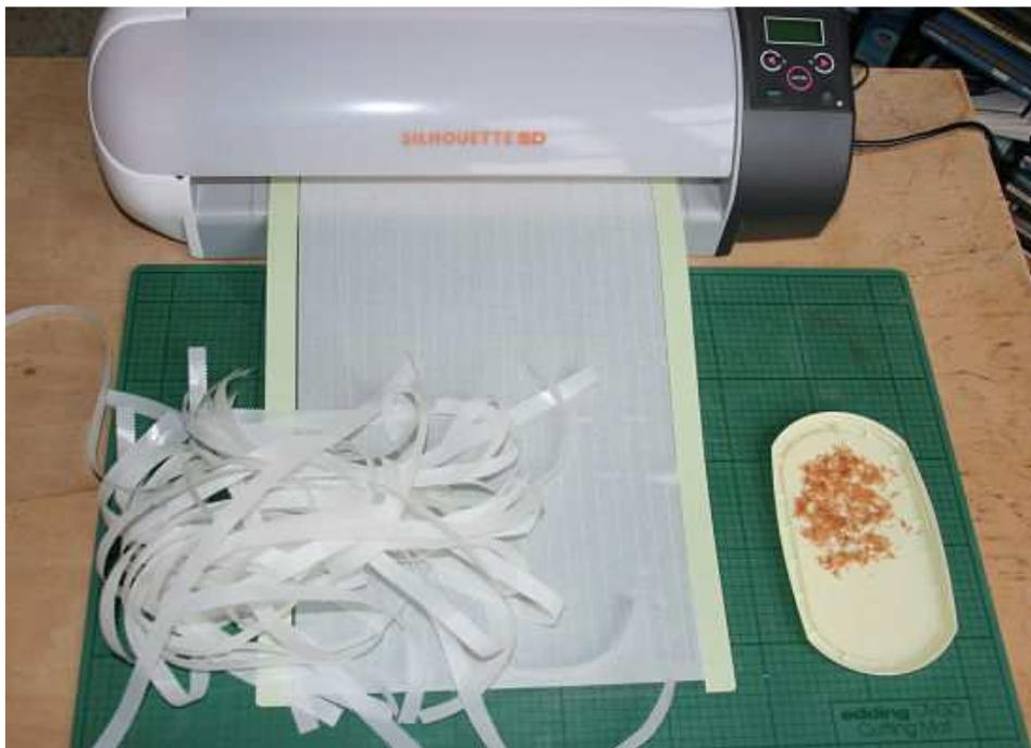
Les bandes crantées sont découpées à la CraftRobo dans de l'Oratex nature, le Diacov est trop résistant et souple pour être coupé proprement avec la machine. Il y a besoin de 43 mètres de bandes crantées, soit 2h30 de découpe machine. A droite 2500 petits morceaux de fil de 4mm de long pour simuler le lardage.
