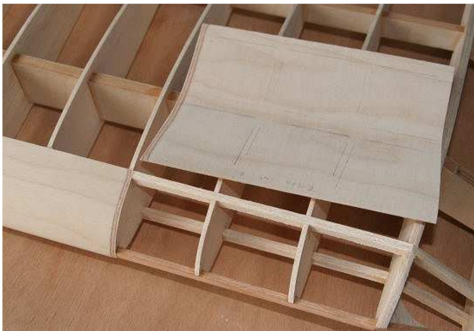
Coffrage des caissons de bord d'attaque avec du CTP de 0.6mm. Les panneaux sont pré-formés en les mouillant à l'eau et en les laissant sécher en place. Les joints de panneaux sont enturés, collage à la vinylique. Le panneau est posé en commençant par l'extrados et en l'alignant sur le longeron, à l'intrados le panneau est plus large de 1cm, ce qui permet d'avoir une prise pour le tirer et de bien le plaquer sur les nervures.
