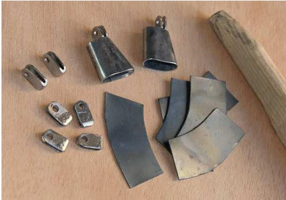
Les pièces d'extrémités sont pliées dans de la tôle de 1mm. Les embouts de mâts sont découpés dans de la tôle de 0.6mm, chauffés au rouge afin d'être plus maléables et mis en forme sur un morceau de bois dur.
