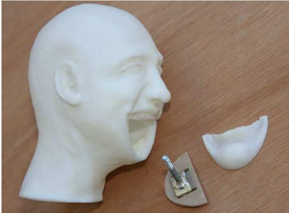
Moulage d'une tête avec simplement de la résine PU, sans mousse PU à l'intérieur + un autre moulage de la partie basse du visage car il n'est pas possible de la récupérer de la découpe. Voir explications moulage <http://www.retroplane.net/modelage/>
