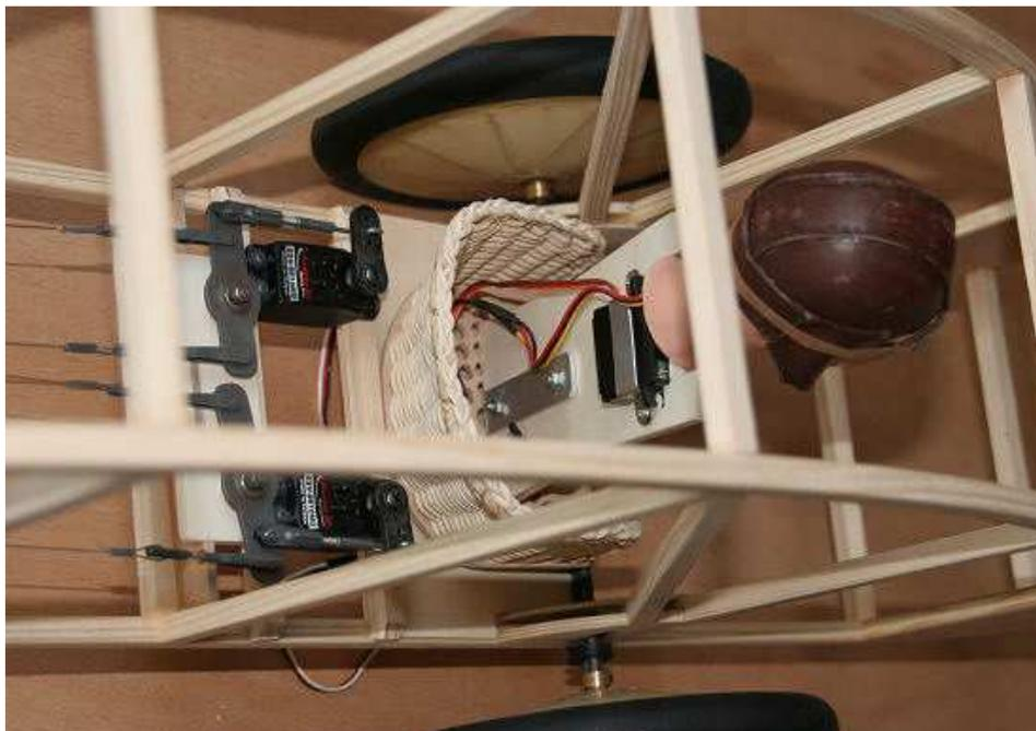
Le corps du pilote est en CTP de 6mm, un servo actionnera le bras gauche. Le siège est solidement fixé sur du pin 9x9 et sur le plancher. Le corps du pilote est vissé sur le siège.
