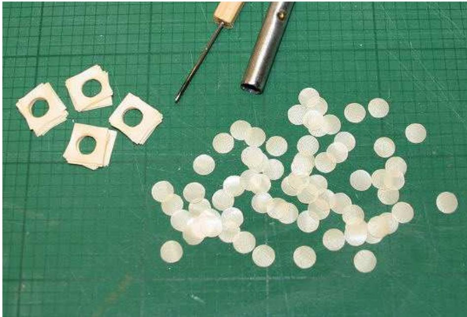
Les oeillets d'aérations d'intrados sont coupés à l'emporte pièce (tube 8x7 affûté à la lime) dans de l'Oratex Antik. Les trous sont faits après collage des oeillets en chauffant une CAP de 1.5mm.
