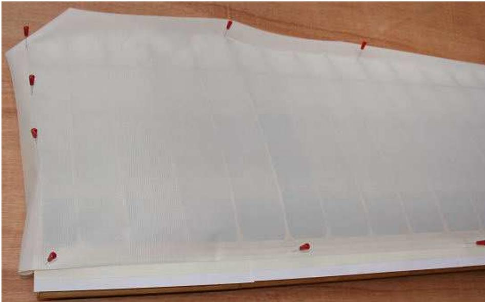
Une bande de scotch de masquage est collée à 9mm du bord du coffrage, une bande de papier est glissée sous le scotch afin de n'avoir que quelques mm de collant et éviter toute mauvaise surprise du scotch chauffé sur le vernis qui pourrait laisser des traces de colle.
