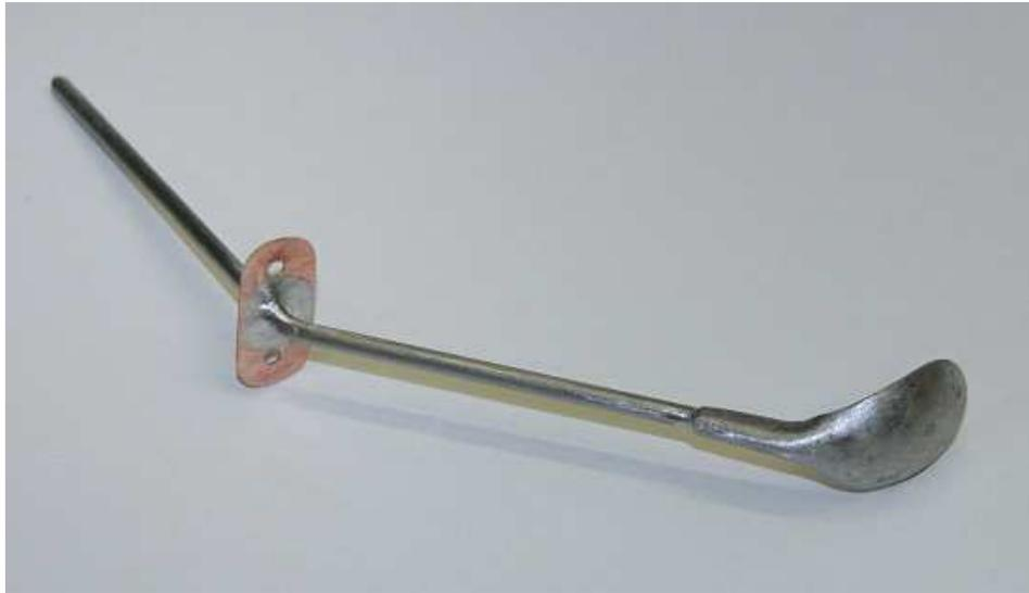
La béquille de queue démontable par 2 vis, est en CAP de 3mm. La "cuillère" est martelée dans une tôle d'acier de 0.6mm.
