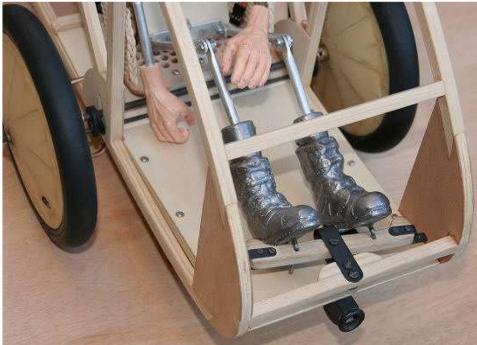
Le palonnier bouge sans forcer en entrainant les bottes et les jambes. Il est relié par câbles au palier de direction, du côté droit en direct, du côté gauche avec une poulie pour dévier sa trajectoire.
