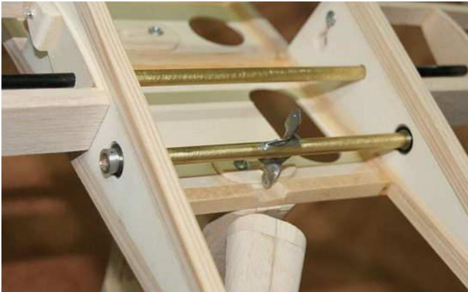
Les flancs du fuselage reçoivent les roulements de 7x14x5. L'ensemble tube/roulements est enfilé et collé en place en infiltrant délicatement de la cyano, puis un tout petit congé d'époxy.
