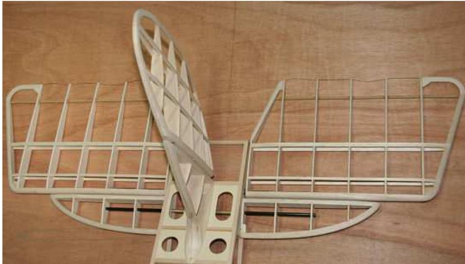
Les volets sont en place. Il ne reste plus qu'à cogiter 2 charnières en bout des parties fixes pour soulager ces énormes volets. L'axe devra être déporté au même niveau que celui des joncs fibre, ces charnières devront être démontables rapidement.
