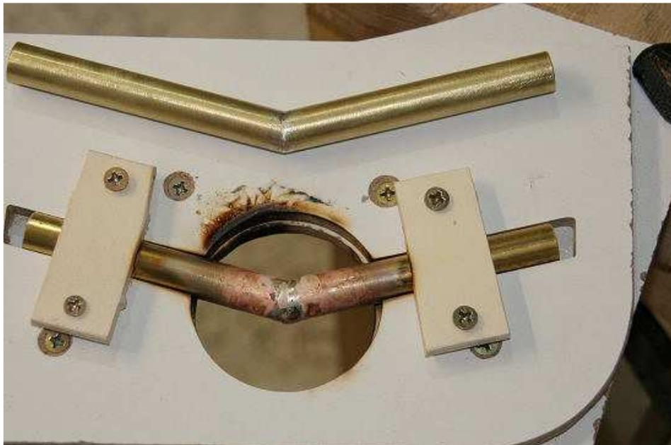
Les fourreaux de clés du fuselage sont en tube laiton 12/13, brasés à l'argent selon l'angle du dièdre. Les clés sont des joncs de fibre de verre de 12mm.
