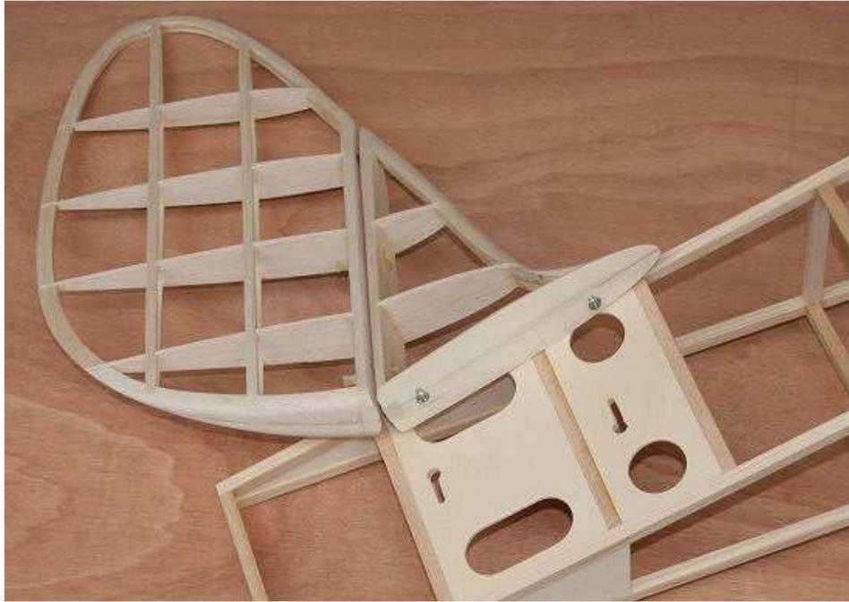
La dérive est démontable pour faciliter le transport du planeur. Son montage est ultra rapide, il suffit de placer les têtes des vis au dessus des trous du fuselage et de faire pivoter l'ensemble jusqu'à buter. En serrant plus ou moins les vis, on règle la dureté de montage et de maintien, aucun risque de bouger en vol.
