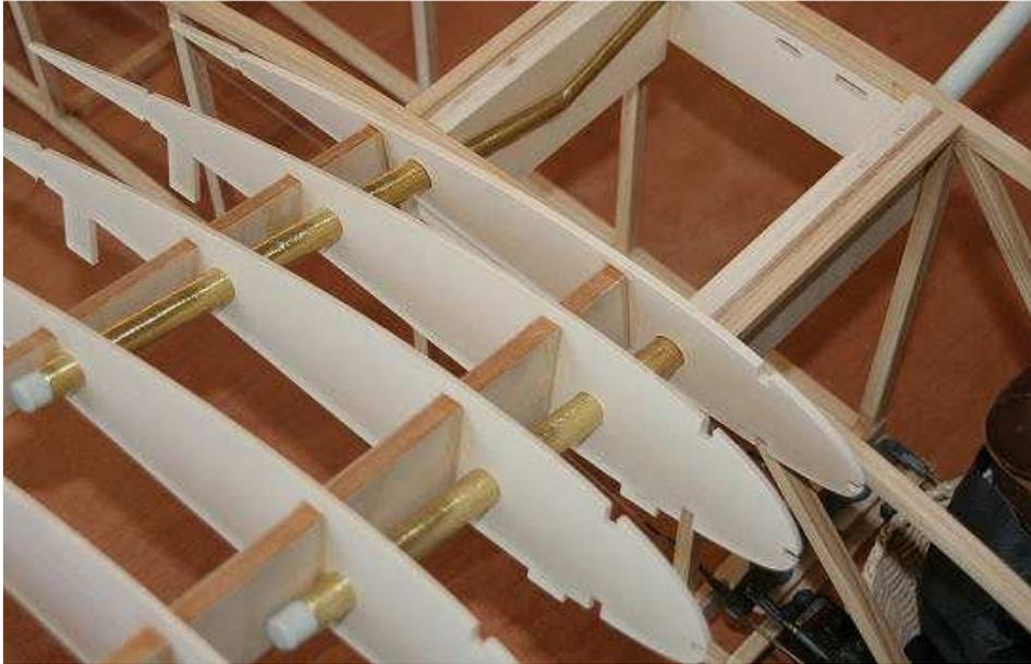
N1 est collée sur les longerons en enfilant l'aile sur ses clés, afin de bien la plaquer au fuselage, on remarque d'ailleurs que N1 est en biais par rapport aux autres nervures, dû à la projection combinée du dièdre et de la flèche.
