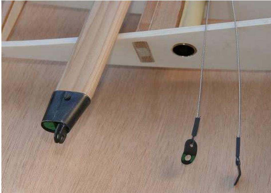
Les haubans peuvent se replier et rester sur les ailes pour leur transport, en cas de démontage complet, j'utilise sur tous les haubans de mes planeurs, un code couleur qui permet de les repérer rapidement sans se tromper: rouge > bâbord/gauche, vert > tribord/droit, un point pour l'avant et 2 pour l'arrière.
