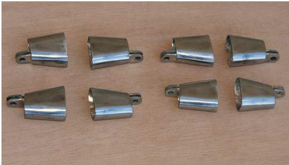
Les joints et les attaches d'extrémités sont brasés à l'argent. Ces pièces sont bronzées au Klever
