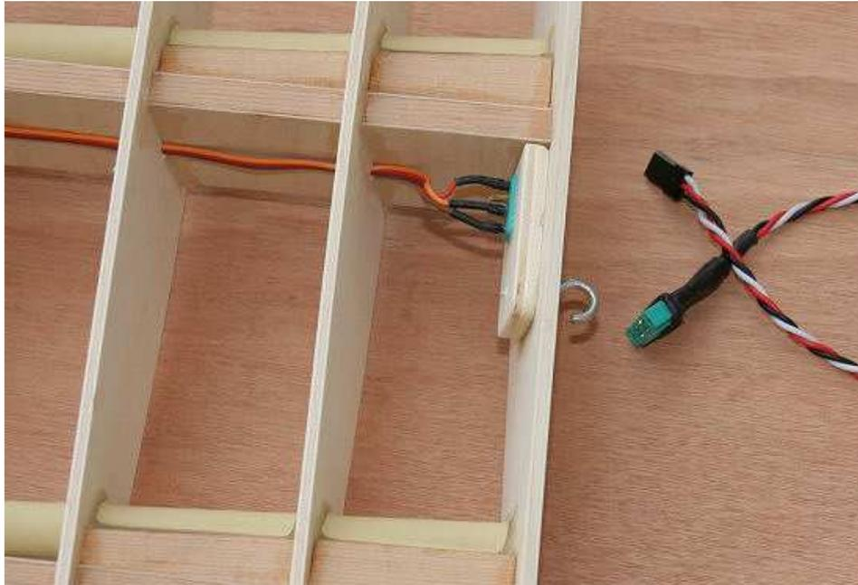
Une prise 6 broches est collée sur l'emplanture de l'aile, côté fuselage la prise est laissée libre. Les ailes sont retenues au fuselage par des pitons/élastiques.
