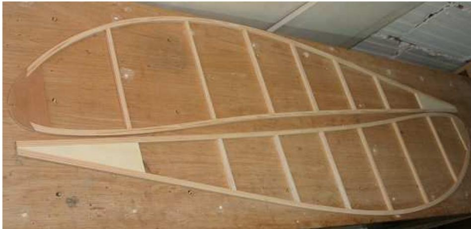
Les 2 flancs sont démoulés du chantier, il reste à les assembler par des traverses de pin de 8x8 à l'avant et balsa à l'arrière
