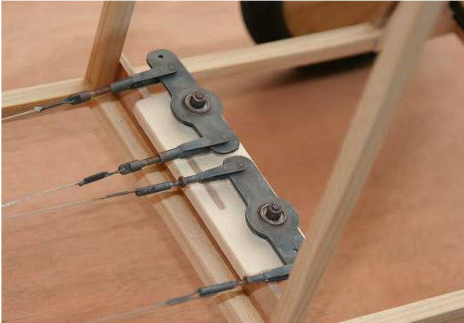
Les commandes par câbles aller/retour sont installées. Les paliers sont en époxy cuivré double face avec des roulements à billes de 3x10x4 soudés à l'étain (j'achète ces roulements chez vxb.com). Les câbles acier inox gainé nylon se trouvent au rayon pêche chez Decathlon en bobine de 10m. Câbles 15kg pour la direction, avec chapes de 2mm. Câbles 41kg pour la profondeur avec chapes de 3mm.
