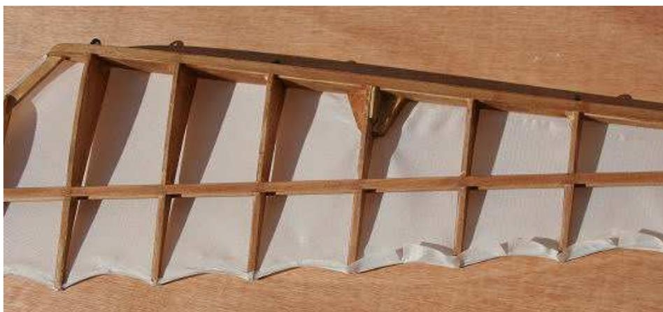
Un coup de ciseaux est nécessaire entre les nervures et à leurs extrémités pour que le rabat du tissu entoure bien le câble de bord de fuite.
