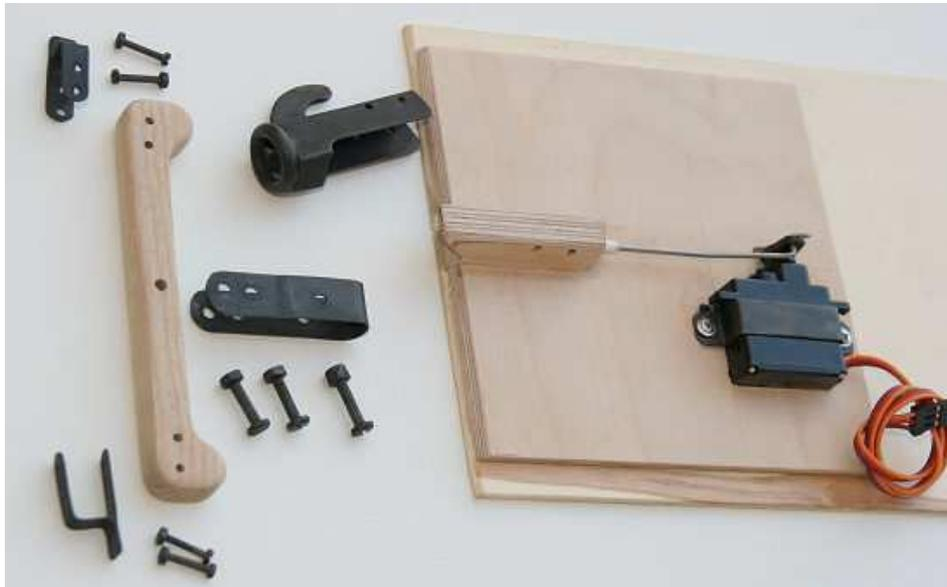
Sous le plancher avant, est collé un CTP de 3mm multiplis, entaillé aux dimensions du servo et du crochet de remorquage. L'habillage du crochet est en tôle d'acier pliée et brasée à l'agent, à l'avant est brasé un anneau récupéré d'un piton. Dessous est brasé le crochet de treuillage en acier de 1.5mm. Le palonnier est découpé dans du frêne, les ferrures sont en tôle d'acier. Tout est bronzé au Klever.
