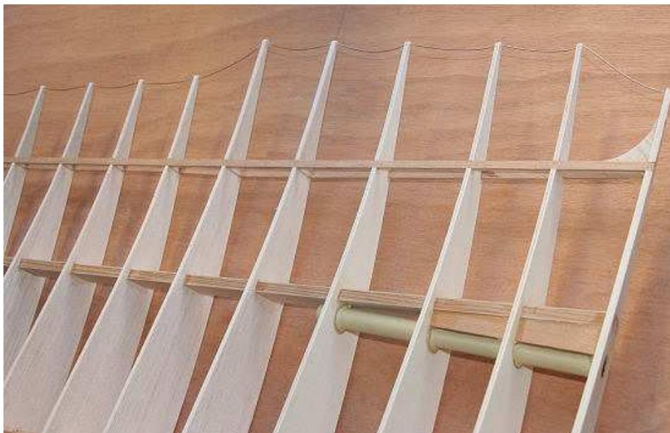
Les bords de fuite sont en câble de 0.8mm. Afin d'obtenir un cintrage bien visible, toutes les 5 nervures j'immobilise le câble à la cyano en laissant 5mm de plus, ce qui fait 1mm de mou entre chaque nervure. Le câble est ensuite collé à chaque nervure.
