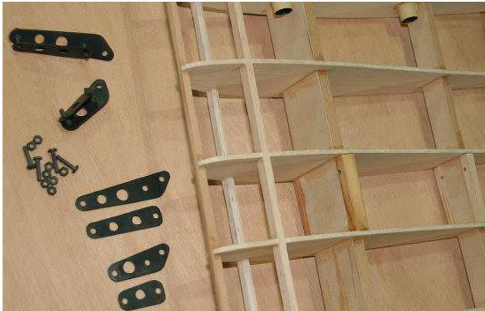
Les ferrures d'attaches de haubans sont découpées aux cisailles dans de la tôle d'acier de 1mm. La contre-plaque est en acier 0.8mm, vis de 3mm. Brunissage au Klever. Le vissage se fait sur un garnissage en sapin collé sur les longerons poutre afin de ne pas les percer.
