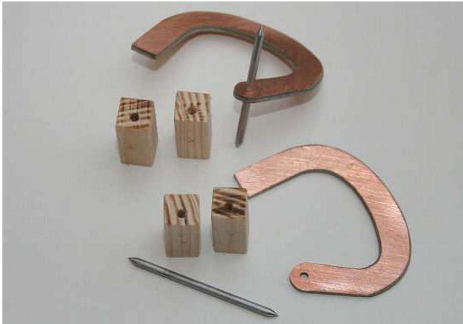
Les charnières en bout de parties fixes sont découpées dans de l'époxy cuivré double face, l'axe est en CAP de 2mm. Les paliers sont en pin 9x9, les axes de perçages sont à 3mm du bord afin d'être alignés avec l'axe d'articulation des joncs fibre. Après avoir enfilé les volets mobiles, il suffit de basculer les charnières dans les logements des parties fixes et de les visser.
