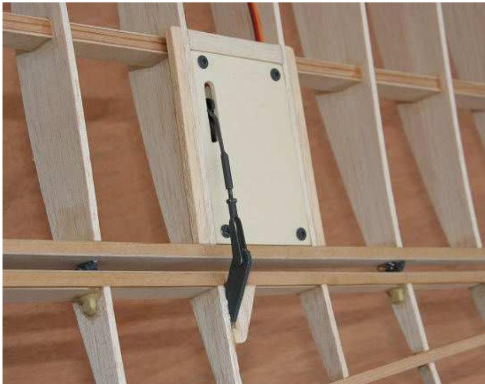
Le servo d'aileron est fixé sur la trappe, qui est vissée sur l'aile. Une prise permet de démonter l'ensemble rapidement.
